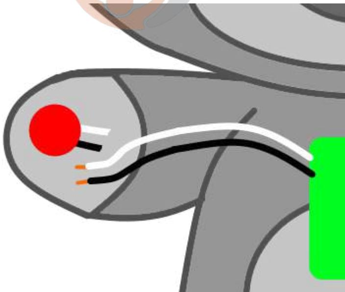
На третьем шаге мы должны аккуратно припаять два контакта внешнего разъема для соединения с контактами, идущими к микросхеме.
