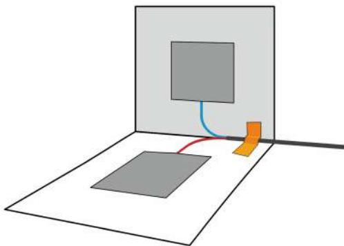
Чтобы кнопка не оставалась в закрытом состоянии, можно на край внутренней нижней стороны приклеить кусочек поролона.
