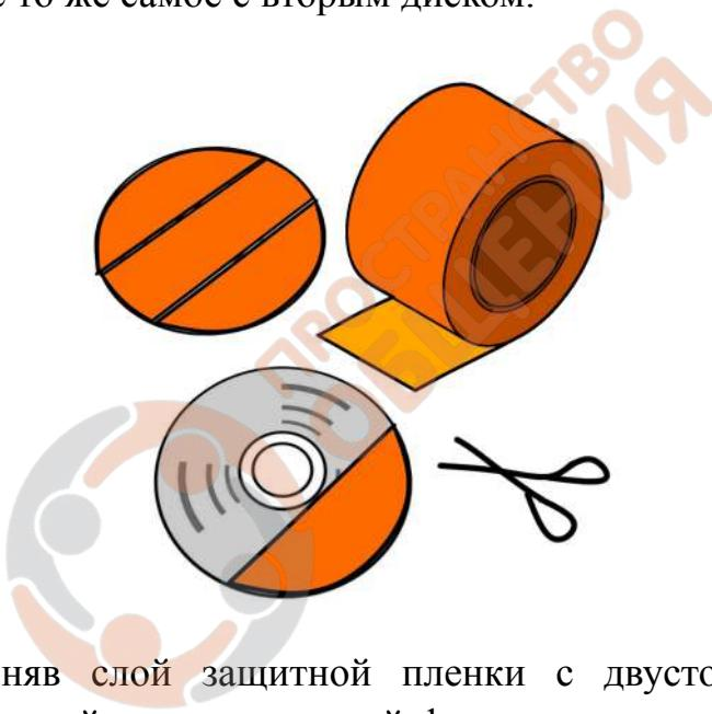
Затем, сняв слой защитной пленки с двустороннего скотча, наклейте на диски слой фольги, лишнюю фольгу по краям обрежьте.
