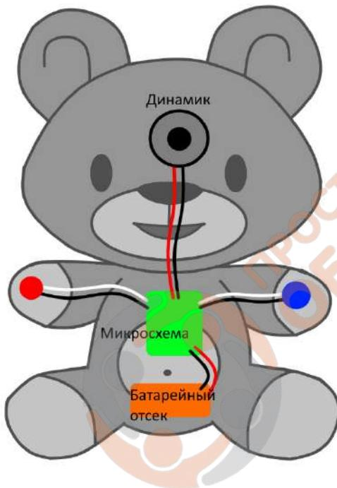
Внутри игрушка состоит из нескольких функциональных блоков: батарейного отсека, микросхемы, где записаны все песенки и стишки, динамика, который будет их проигрывать, и органов управления (в данном случае это две тактовые кнопки, отмеченные на схеме красным и синим кругами).
